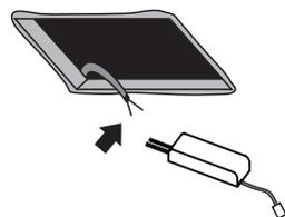
Com a rede elétrica desligada, ligue os cabos do driver.
