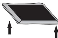
Faça um rebaixo no perímetro do corte no gesso para encaixar o batente da luminária
