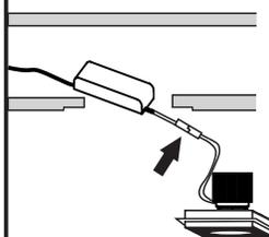
Após ligar o driver conecte os cabos da luminária e coloque-o dentro do forro.
